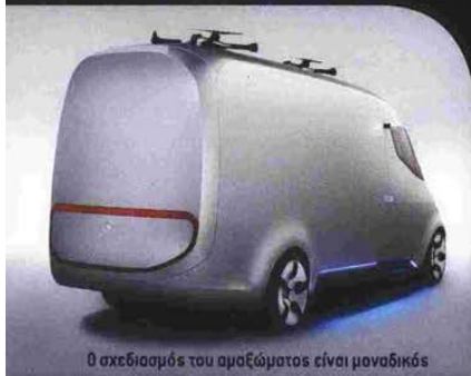
Το Vision Van φέρει δύο σταθμούς προαγείωσης για drones στην οροφή του
